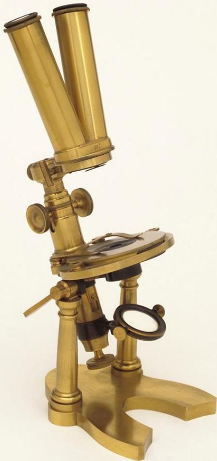
Microscopio composto binoculare montato su base a ferro di cavallo.
